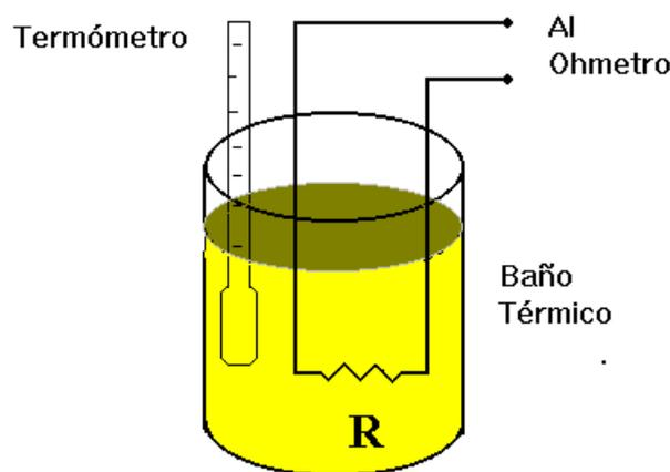
**Figura 1.** Dispositivo experimental para medir la variación de la resistencia con la temperatura. El baño térmico (termostato) consiste en un recipiente con un líquido de poca conductividad eléctrica. Se requiere de un termómetro y un multímetro (en modo óhmetro) para medir la resistencia  $R$  como función de la temperatura.
