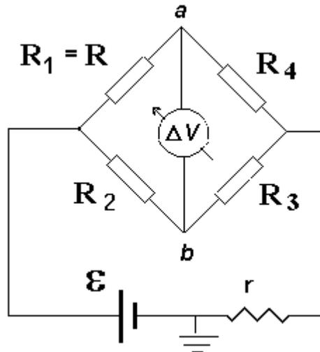
**Figura 2.** Puente de Wheatstone para estudiar la variación de  $R$  con  $T$ . Aquí suponemos que la única resistencia a la que se le varía la temperatura es  $R_1$ ; las demás resistencias permanecen a temperatura ambiente.
