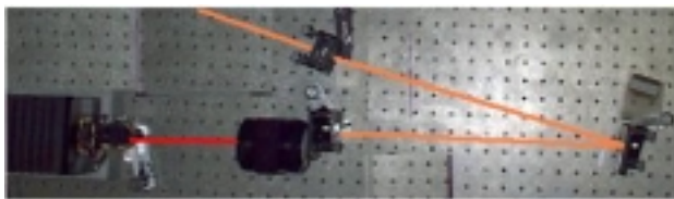
Figura 2. Cavidad en V para un láser Nd:YAG.
