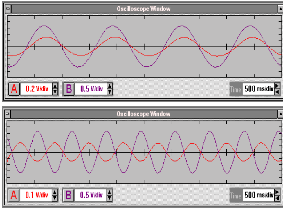
Figura 18 Evolución de las señales en el osciloscopio. En la pantalla superior se observan las señales en fase para frecuencias mucho menores que la de resonancia. En la pantalla inferior se observa un desfase de 180° a frecuencias mayores que resonancia.
