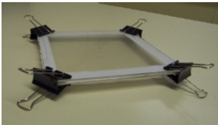
Figura 1: Celda de Hele-Shaw construida para este trabajo. La celda es de acrílico. Los separadores de papel en cada borde aseguran una separación uniforme entre las placas.
