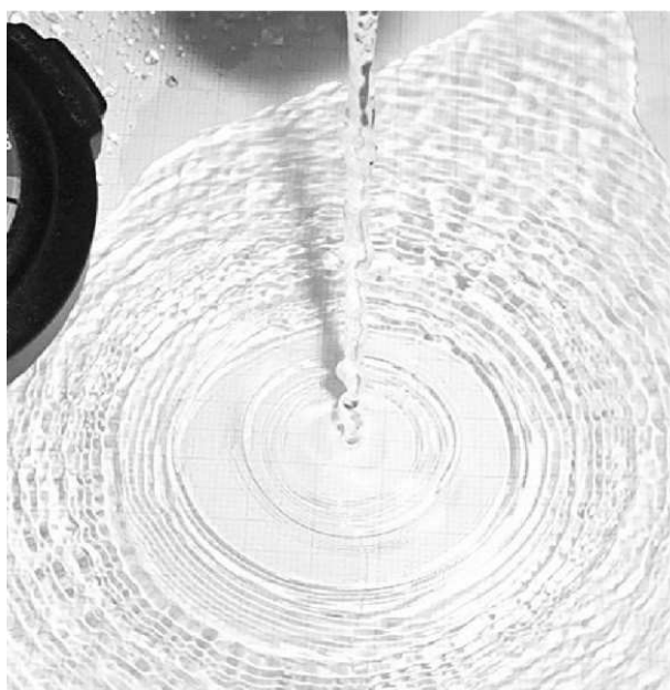
Figura 9: Fotografía del salto hidráulico con ondas internas. Pueden verse las ondas formadas en el delgado film sobre la placa y un jet continuo.
