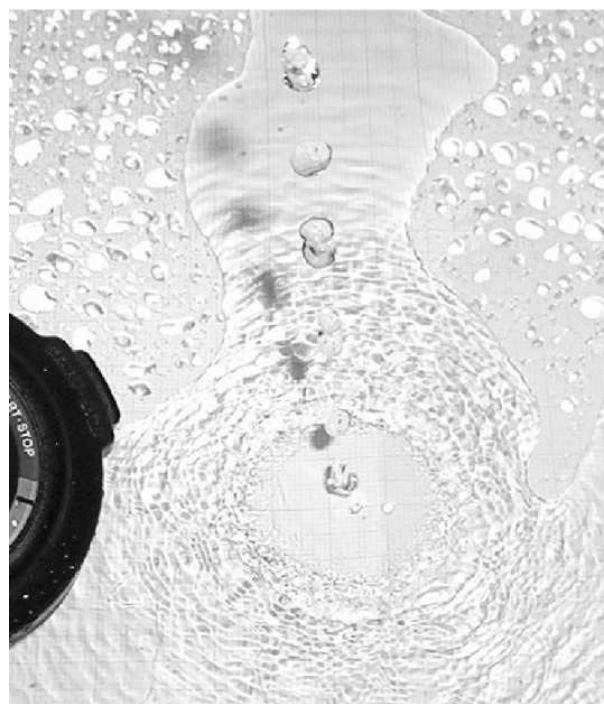
Figura 8: Fotografía del salto hidráulico irregular. Pueden verse las gotas provenientes del reservorio (botella) y las ondas formadas en el delgado film sobre la placa.
