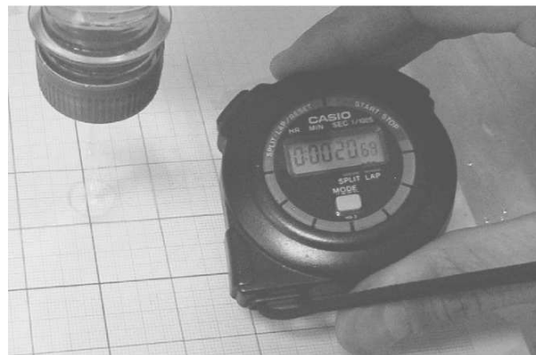
Figura 10: Fotografía del salto hidráulico. Puede verse el pico de la botella en la esquina superior izquierda y el pequeño salto hidráulico circular debajo.
