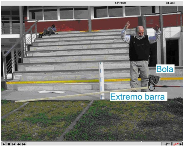
FIGURA 5. En la figura superior el fotograma que muestra la bola y la varilla de madera cuando comienzan a caer. La bola y el extremo de la varilla están a la misma altura respecto del suelo y el ángulo inicial de la barra es 32^\circ . En la figura inferior, se observa que durante la caída, el extremo de la varilla avanza más rápido que la bola.
