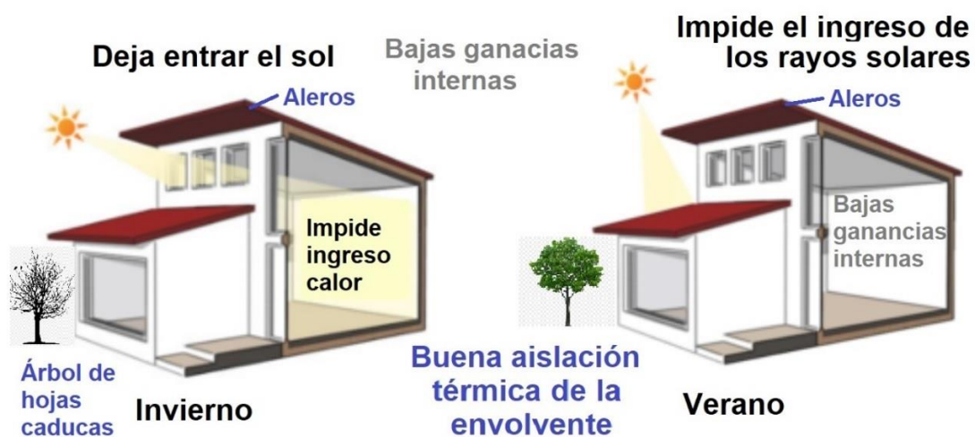
Figura 6. Algunas medidas de refrescamiento pasivo. Aleros en ventanas al norte y árboles de hojas caducas, que permiten el ingreso de sol en invierno, pero lo impiden en verano.
