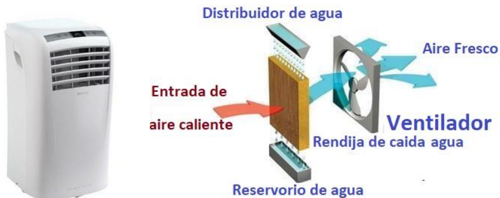
Figura 7. Climatizador evaporativo para refrigeración. A la derecha se ilustra su funcionamiento, por una rejilla húmeda, se fuerza con el ventilador una corriente de aire caliente del medio. El agua de la rejilla se evapora absorbiendo calor, por lo que el aire se enfría y es impulsado al exterior. Así se genera un flujo de aire algunos grados más fríos que el entrante. Muy adecuado para climas secos, pero aun en el AMBA funcionan adecuadamente.
