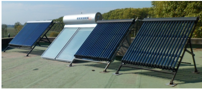
Figura 5. Cuatro colectores solares que se utilizan en el presente ensayo. Como se aprecia se están ensayando dos tecnologías diferente de paneles solares: placa plana con cubierta y tubos de vacío (Placco, Saravia, & Cadena, 2007).
