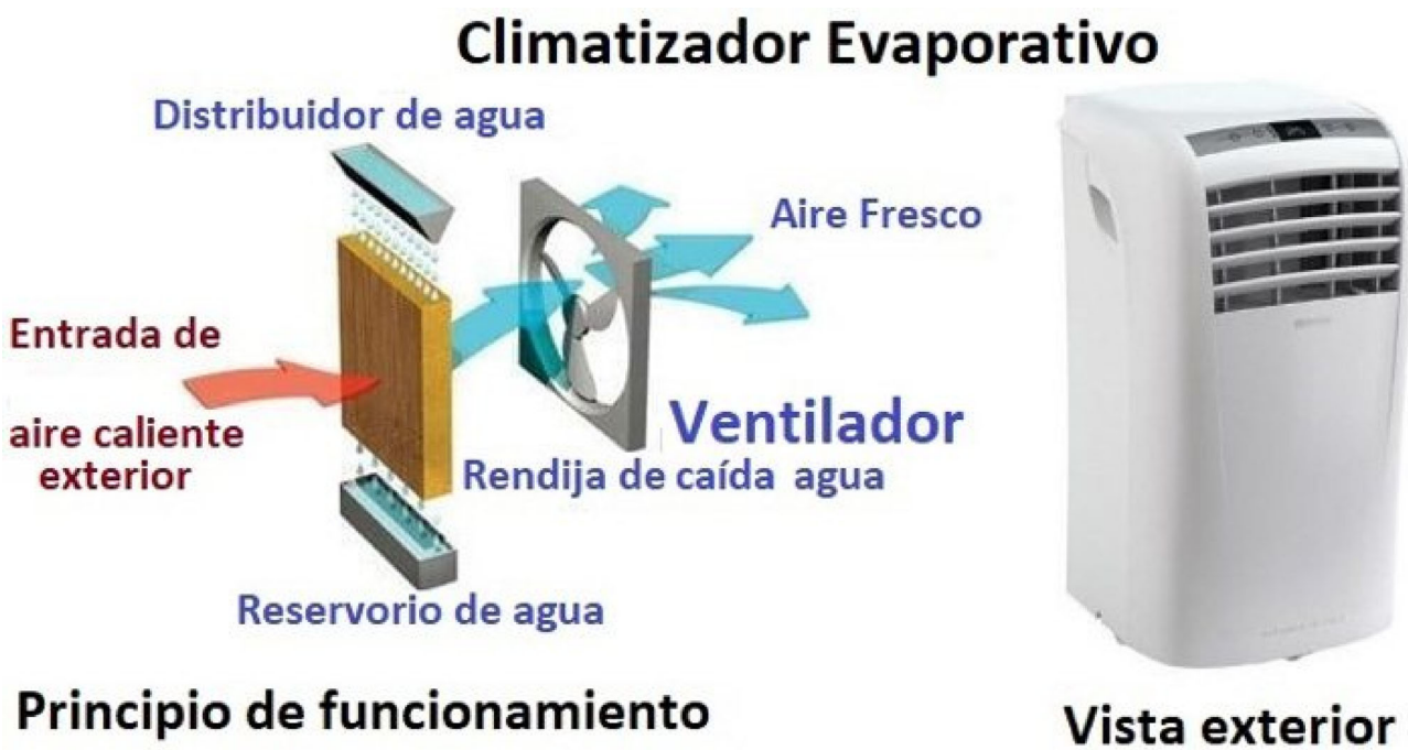
Figura 13. Climatizador evaporativo para refrigeración. A la izquierda se ilustra su funcionamiento, por una rejilla húmeda, se fuerza con el ventilador una corriente de aire caliente de medio. El agua de la rejilla se evapora absorbiendo calor, por lo que el aire se enfría y es impulsado al exterior. Así se genera un flujo de aire algunos grados más fríos que el entrante. Muy adecuado para climas de humedad relativa baja (secos). Fuente: Elaboración propia.
