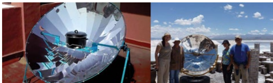
Cocina solar de concentración de la radiación por medio de espejos parabólicos. Fundación Ecoandina.
