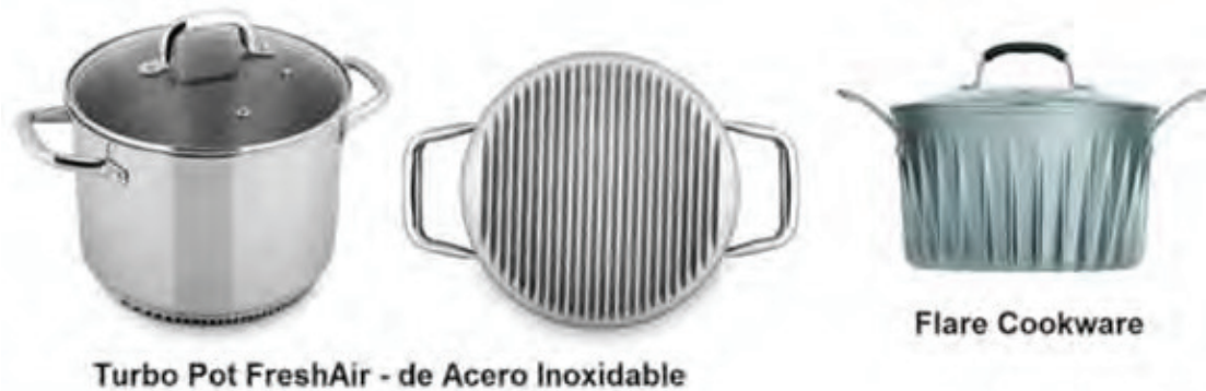
Figura 6. Dos modelos comerciales de ollas con aletas o estrías. Estas estrías hacen más eficientes la transmisión del calor de la llama a la olla. Especialmente adecuadas para cocinas a gas. Las mejoras en transmisión de calor pueden ser del orden del 50%. 15
