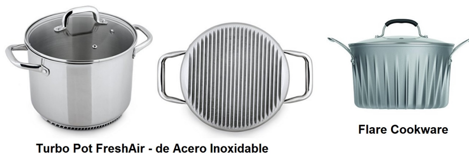
Figura 6: Dos modelos comerciales de ollas con aletas o estrías. Estas estrías hacen más eficientes la transmisión del calor de la llama a la olla. Especialmente adecuadas para cocinas a gas. Las mejoras en transmisión de calor pueden ser del orden del 50%. [20]
