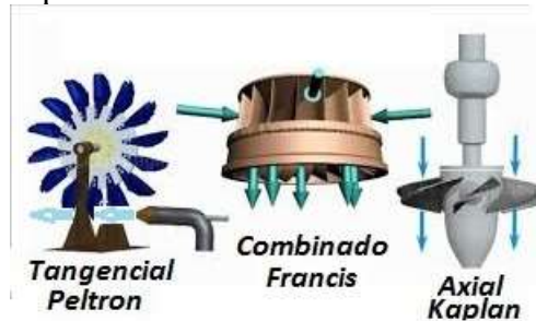
Figura 11. Diferentes tipos de turbinas, en la Peltron el sentido de la velocidad del agua se desvía poco de su dirección inicial, siendo la incidencia perpendicular al eje de la turbina. En la Kaplan , la velocidad de entrada es paralela al eje de la turbina. En la Francis , la velocidad del agua cambia 90° su dirección.
