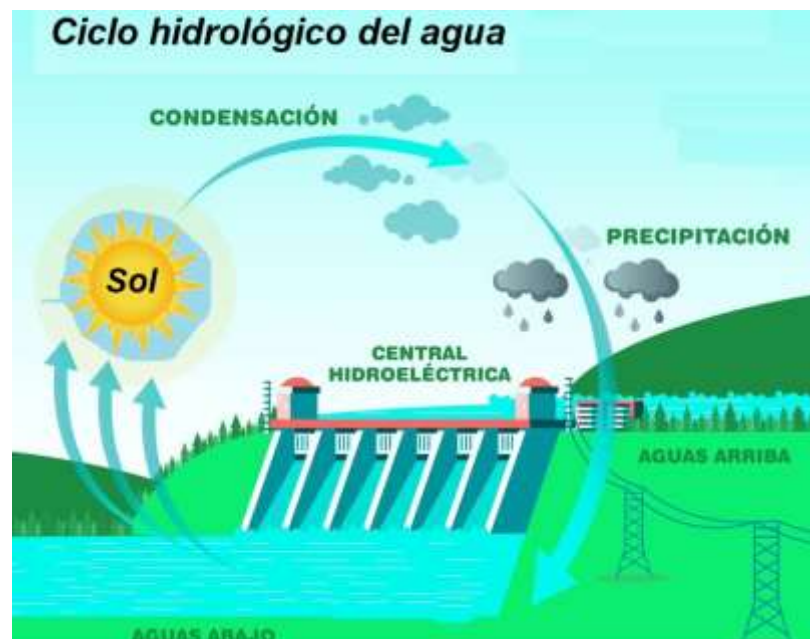
Figura 2. Ciclo hidrológico del agua en la generación hidroeléctrica. Como se ve claramente, la energía que hace posible este proceso, es la energía proveniente del sol. [1]
