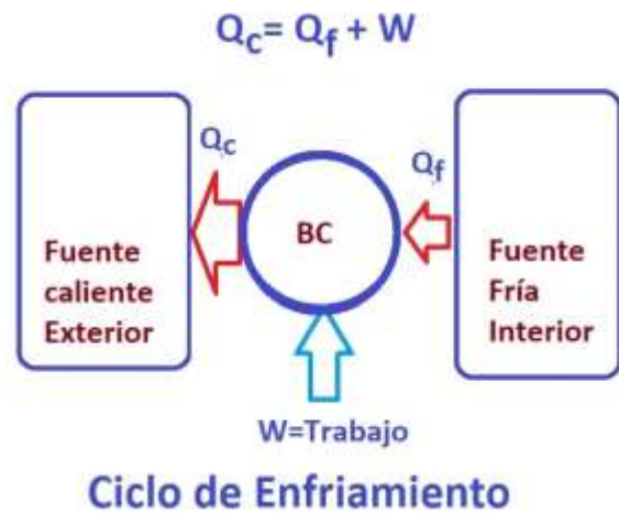
Fig. xx.16. Bomba de calor operando en modo de enfriamiento o Aire Acondicionado (AA).
