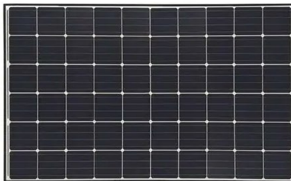
Figura 12. Panel Solar 300W Monocristalino. Los tamaños típicos de estos paneles son de 1.13m x1.72m (1.94 m 2 ) con pesos del orden de 20 kg. Su eficiencia es típicamente de unos 20% al 25%. Su precio varía constantemente, pero para un usuario residencial es del orden de unos 200USD a 300USD en 2023.
