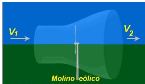
Figura 8. Diagrama esquemático del cambio de velocidad de viento producido por la presencia de un aerogenerador.
