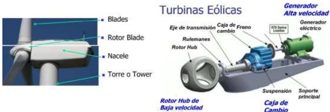
Figura 12. Componentes de una turbina moderna de eje horizontal. A la derecha vemos las principales componentes internas del Nacele o góndola.
