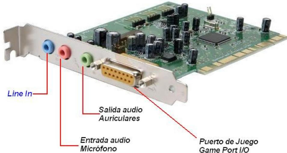
**Fig. 11.1.** Tarjeta de sonido PCI convencional.
