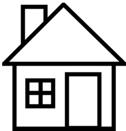
Figura xx.14. Esquema simple de una vivienda. En este caso, tanto las paredes, como el techo, las puertas y las ventanas, son elementos que transmiten el calor en paralelo. Por lo tanto sus transmitancia totales se suman.
