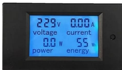
Figura 13: Vista de frente del medidor de consumo. Aquí se indica en modo esquemático en mimo circuito que el de la Figura 1.
