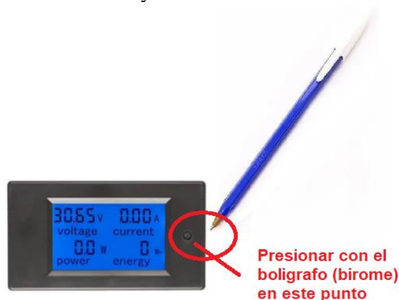
Figura 14: Vista de frente del medidor de consumo- modo de reseteo del indicador de energía (Energy). Con un bolígrafo (birome) presionar sobre el switch o interruptor que se ve a la derecha del display. Indicado por el círculo rojo.
