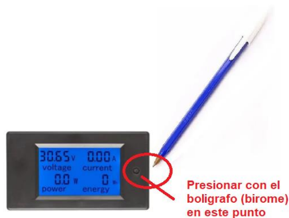
Figura 23. Vista de frente del medidor de consumo- modo de reseteo del indicador de energía (Energy). Con un bolígrafo (birome) presionar sobre el switch o interruptor que se ve a la derecha del display. Indicado por el círculo rojo.
