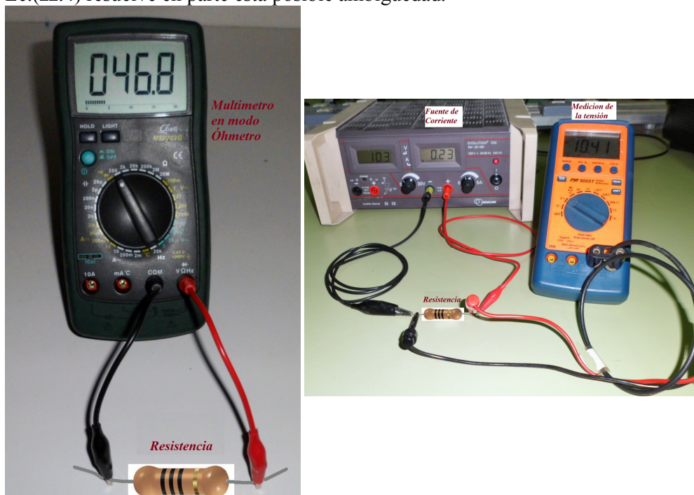
Figura zz.3 Métodos de medición de resistencia a dos puntas (izquierda) y cuatro puntas (derecha) . Algunos instrumentos especiales poseen un arreglo para medir a cuatro puntas directamente. Sin embargo,
